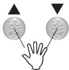
Presionando simultáneamente ▲ ▼ se cambia manualmente el estado del contacto de salida del programa vigente. Cuando se alcanza la activación por otro programa el interruptor nuevamente funciona en forma automática.
