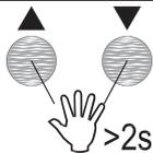
Presionando simultáneamente ▲ ▼ por más de 2s, se modifica el estado del contacto de salida de forma permanente PERM ON/PERM OFF. El icono ✎ destellara ininterrumpidamente.
